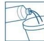
**ANWENDUNG:** **METALLIC 2000** gleichmäßig und dünn mit einem geeigneten Feuchtwischgerät, Lammfell oder einem vergleichbaren Applikator auftragen. Nach vollständiger Trocknung des ersten Auftrags (ca. 20 Minuten) einen zweiten Auftrag aufbringen. Bei saugfähigen Belägen oder wenn ein höherer Glanz gewünscht wird, kann ein dritter Auftrag erfolgen. Für stark saugende Bodenbeläge empfehlen wir den Einsatz von **DURO FILL** als Porenfüller.
